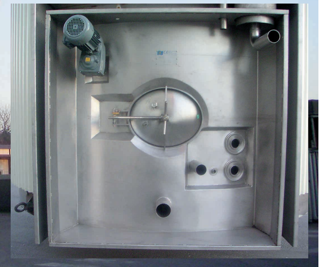
Tankalkov med rörverk, manlucka och fästen för givare
